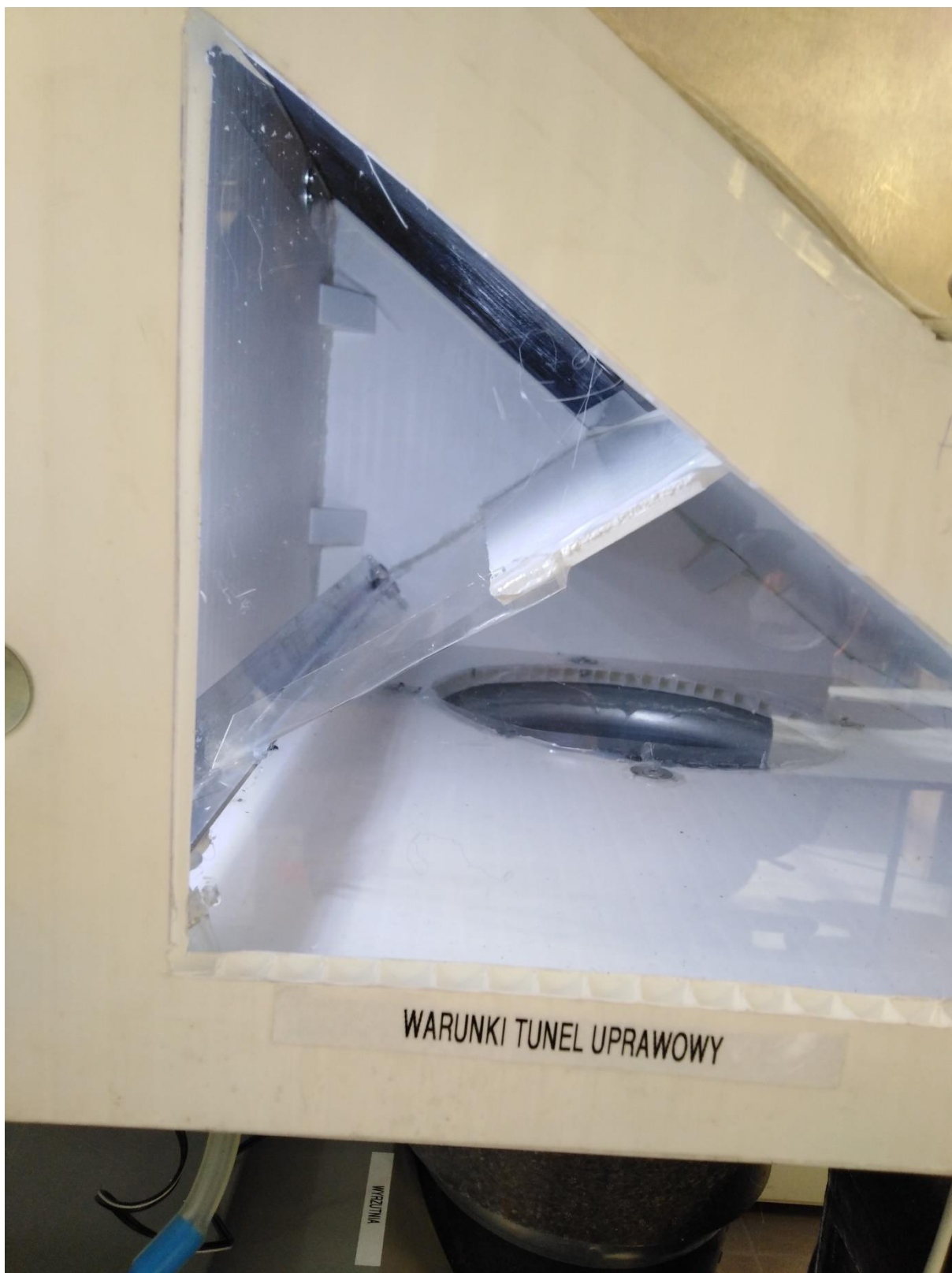
Rysunek 14. Koryto w wymienniku wykonane w celu odzysku wykraplanej wody
